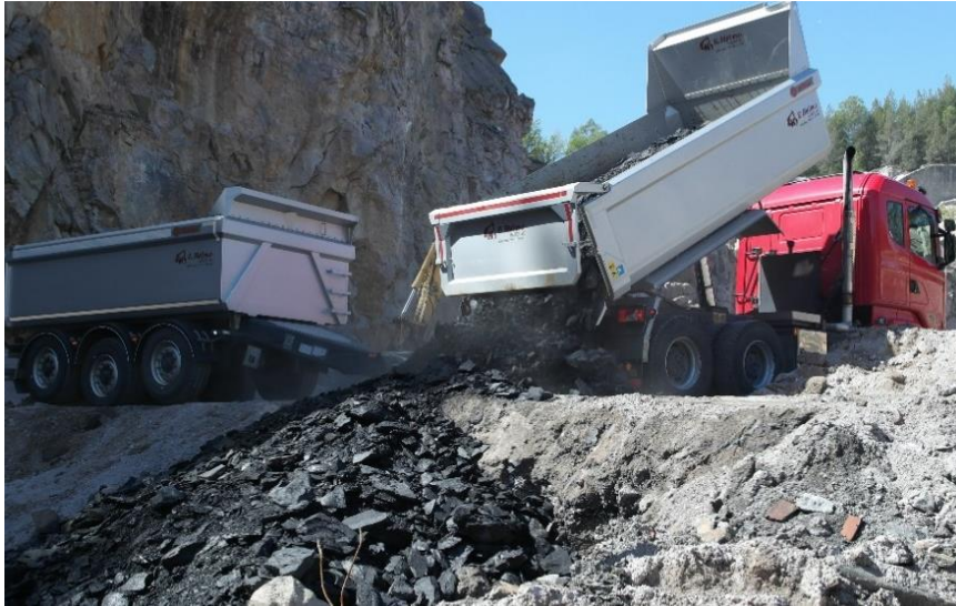
Bilde 2 Deponering og lossing av uforvitret svart potensielt syredannende masser
