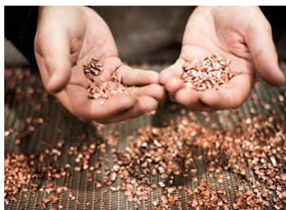
Gjenvinning av kabel og trafo på Linnestad. Det ferdige produktet består hovedsaklig av kobber som erstatter jomfruelige råvarer.
